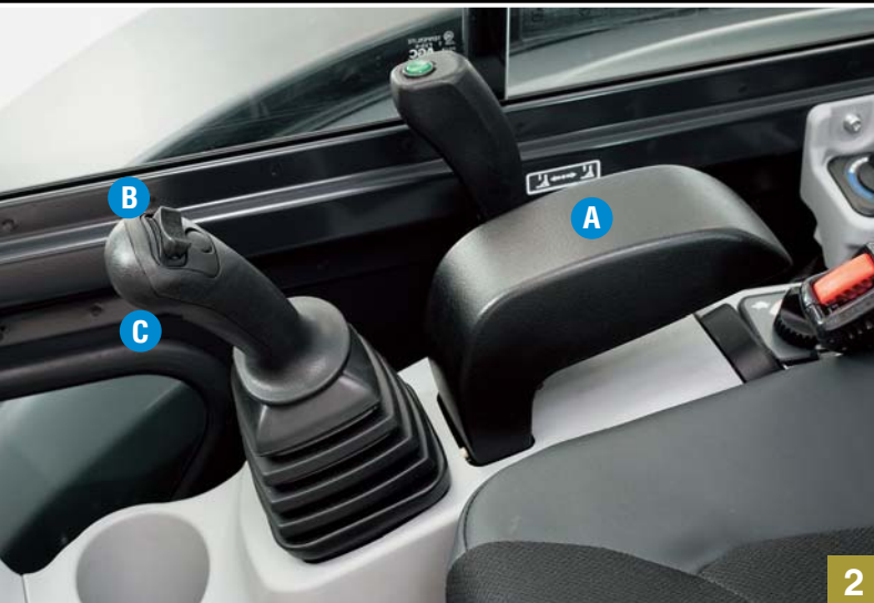
Ajuste del caudal de aceite máximo (circuitos aux. 1 y 2)
