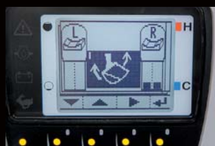
Ajuste del caudal de aceite máximo (circuitos aux. 1 y 2)
