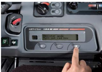
1 Introducir la llave roja de registro y pulsar el botón del panel digital.
